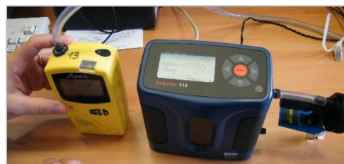
2. Calibración de equipo de muestreo (Bomba de aspiración, ciclón y filtro).
