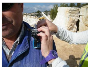
3. Colocación de ciclón y bomba sobre el trabajador (muestreo personal).
