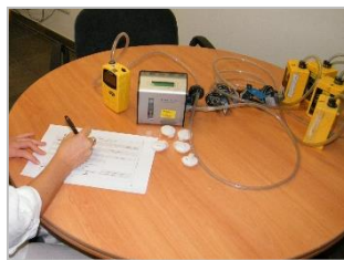
6. Tras comprobación de que la bomba no ha variado su caudal de aspiración en un \pm 5\% , envío de filtros al laboratorio.
