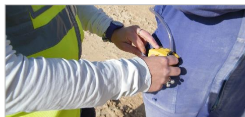
3. Colocación de ciclón y bomba sobre el trabajador (muestreo personal).
